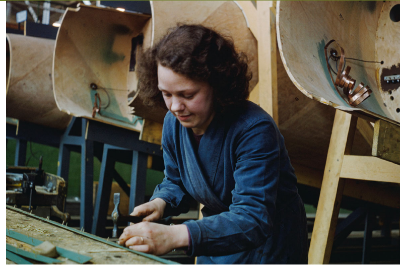
Montage van een Mosquito te Hatfield, duidelijk zijn de houten rompdelen te zien (Imperial War Museums TR930).
