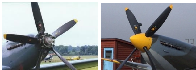
5 bladige Rotol op spitfire Mk XIV 4 bladige Rotol op spitfire Mk IX
